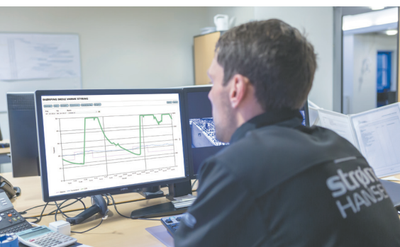
Strøm Hansens klimastyringssystem er udviklet til hhv. at overvåge og styre luftkvalitet og temperaturer på Skørping Skole
